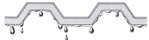
Das Tropfschutzvlies ist eine auf der Unterseite der Trapezprofile aufgebrachte feuchtigkeitsabsorbierende Schicht. Diese bindet Kondenswasser und kann je nach Dachneigung ca. 0,7 bis 0,9 l Wasser pro m<sup>2</sup> aufnehmen. Das ist in den meisten Fällen ausreichend, um das unangenehme Abtropfen zu verhindern.
