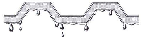
Das Tropfschutzvlies ist eine auf der Unterseite der Trapezprofile aufbrachte feuchtigkeitsabsorbierende Schicht.
