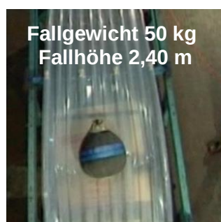
biaxial gereckte Ondex Lichtplatte
