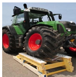
Der Härtestest – biaxial gereckte Lichtplatte gegen Traktor
