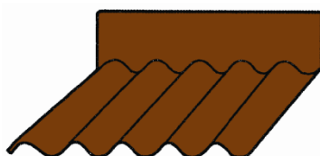
Maueranschlussstück 350/150 mm – IW 127°
