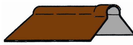
Flachfirsthaube 350/350 mm zweiteilig – Decklänge 1.000 mm
